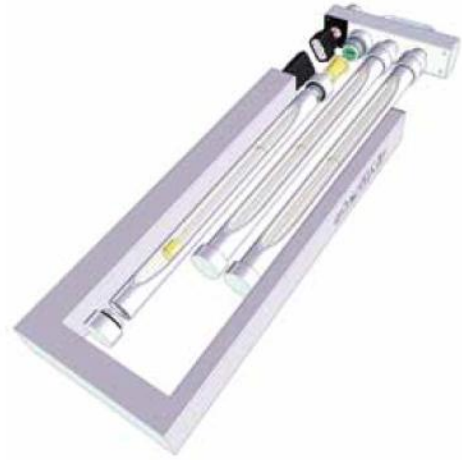
Zerlegebandentkeimer, Grafik erstellt mit Solidworks Composer.
