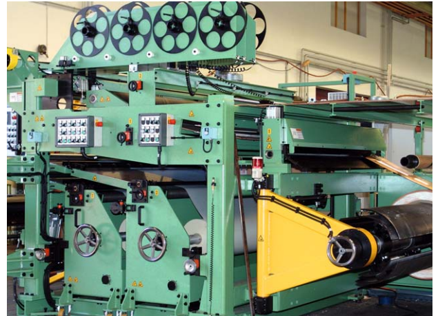
Detailaufnahme der FLCT 1600 Bandwickelmaschine, die aus komplexen Schweiss-Teilen und 9500 Einzelteilen besteht.
