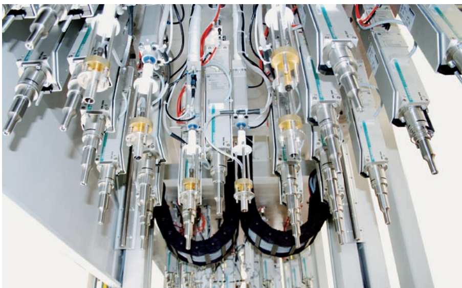
Die Kompaktanlagen des Typs IPA beinhalten Aktuator und Ultraschallanlage in einer kompakten Einheit und eignen sich damit ideal zur Integration in grössere Montageanlagen.
